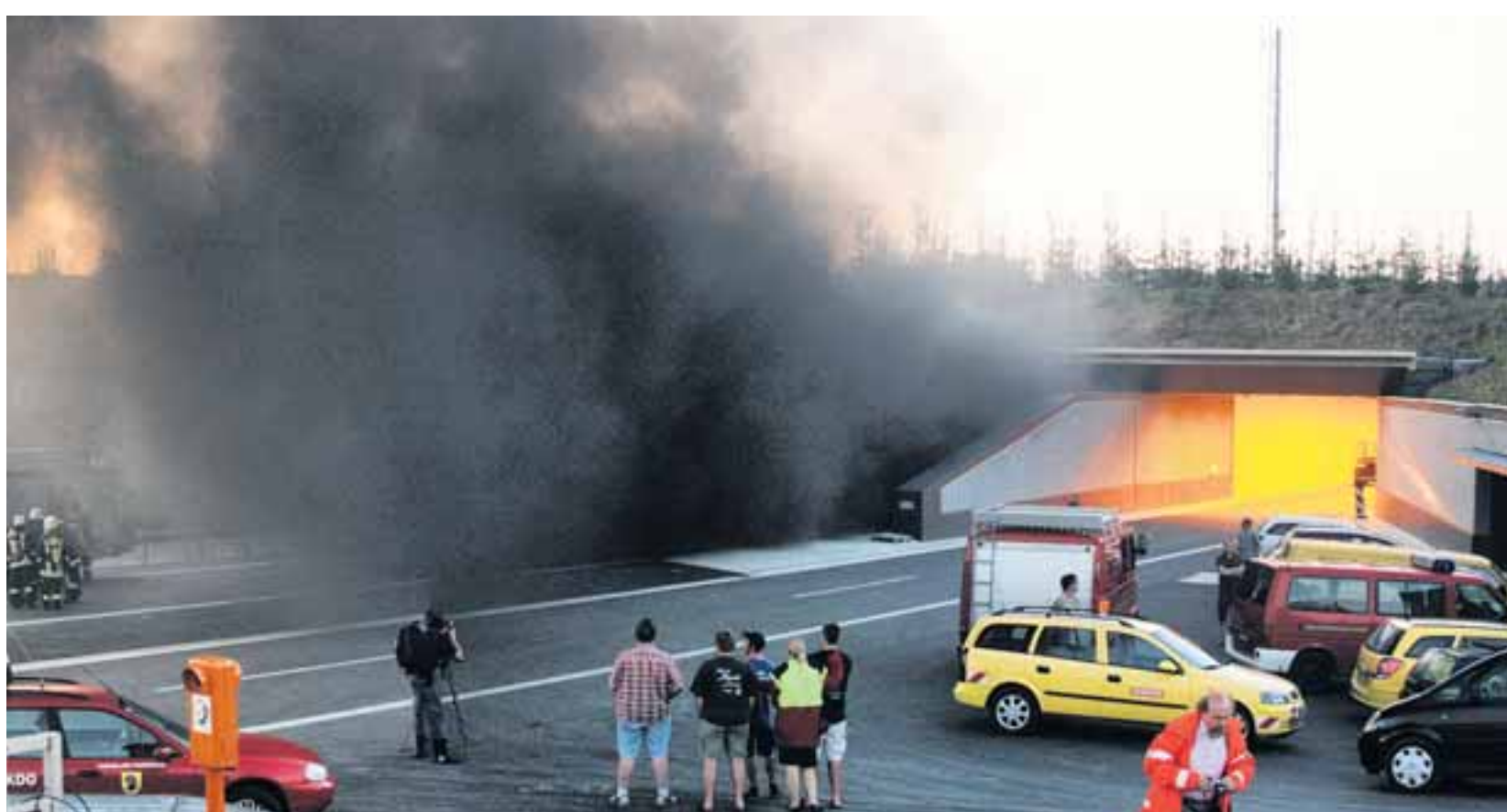
20 Liter mit großer Wirkung: Am Montagabend testete die Firma Osmo ihr Brandschutzsystem im neuen A7-Tunnel bei Reinertshof. Dabei wurden vier Wannen mit je fünf Litern Benzin-Diesel-Gemisch entzündet. Die Feuerwehren aus Füssen, Nesselwang und Vils nutzten den Versuch für Übungszwecke. Foto: Christian Steinmüller
