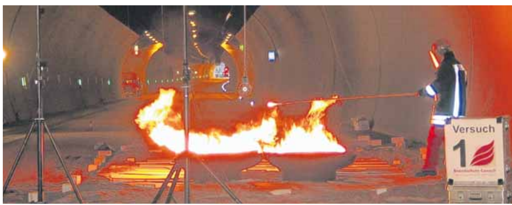
20 Liter Treibstoff wurden im leeren A7-Grenztunnel in Brand gesetzt, um die einwandfreie Funktion der Brandmeldeanlage zu testen. Die Füssener Feuerwehr nutzte dies für eine Übung ihrer Atemschutzträger. Der Tunnel ist wegen turnusgemäßer Wartungsarbeiten bis Freitagnachmittag gesperrt. Fotos: Feuerwehr
